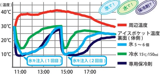
測定結果 それぞれ上記の3通りの使い方で冷却効果温度グラフ。最初、1回目の氷や冷水等の冷却源を注入、その後約4時間経過後の午後2回目の注入を行った。それぞれ3通りの使い方でアイスポケット部の裏面周辺に長時間の冷却効果をもたらすことが分かります。
