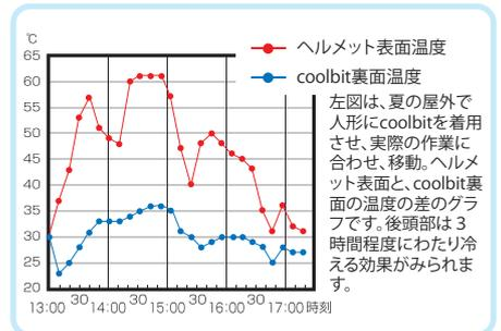
左図は、夏の屋外で人形にcoolbitを着用させ、実際の作業に合わせ、移動。ヘルメット表面と、coolbit裏面の温度の差のグラフです。後頭部は3時間程度にわたり冷える効果がみられます。
