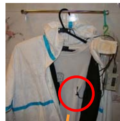
温度センサーNo2 ベスト前面の裏位置 (下着に貼り付け)
